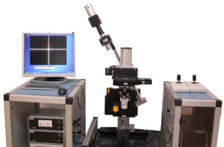
Bild: MTF_Messgerät für die Messkonfiguration unendlich/endlich, senkrechter Aufbau
