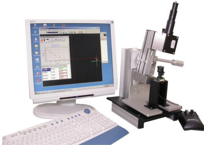
Bild oben: Beispiel für Messaufbau zur Justierung von CCD-Chips in kameras nach dem Kriterium der besten MTF
